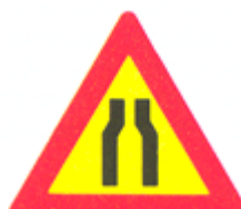
(K-5) Επικίνδυνη στένωση οδοστρώματος και στις
