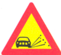
(K-13) Επικίνδυνη εκτίναξη χαλίκων, (ασύνδετο αμμοχάλικο)
